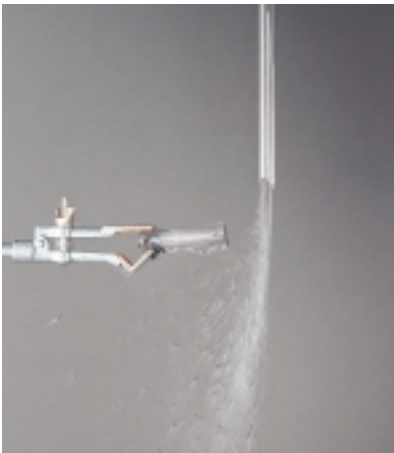
■ Abgelenkter Strahl aus Eisenspänen.
